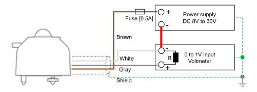
Figure 5-9. How to connect MS-80S (0-1V output)
