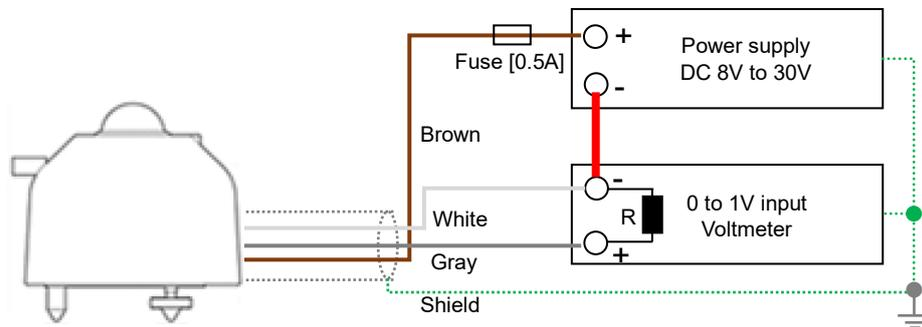
Figure 5-9. How to connect MS-80S (0-1V output)
