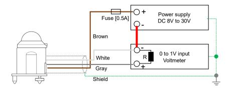
Figure 5-6. How to connect MS-60S (0-1V output)
